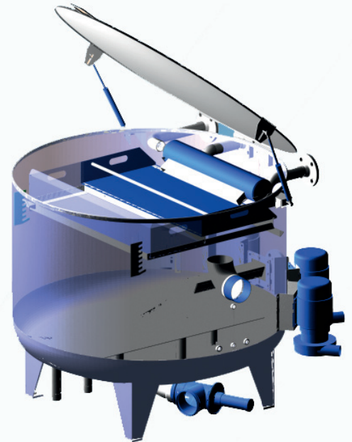
Rückgewinnungsbehälter in der CAD Darstellung
